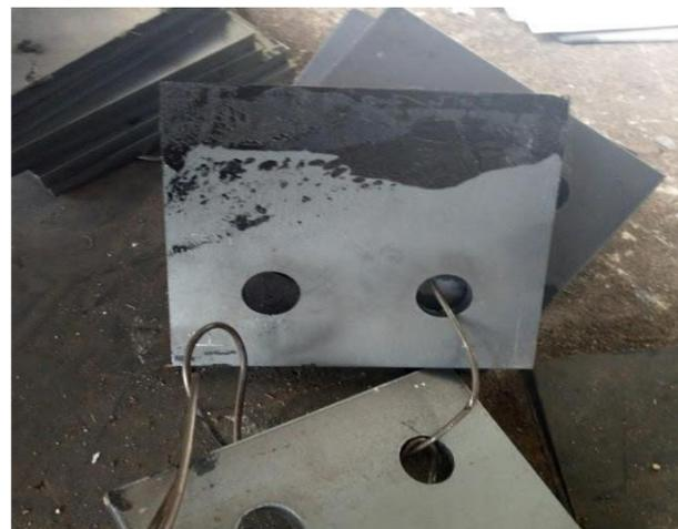
不めっき塗料が乾燥していない状態で製品同士を重ねた場合、めっきを必要とする箇所に不めっき塗料が付着し、不具合が生じます。
